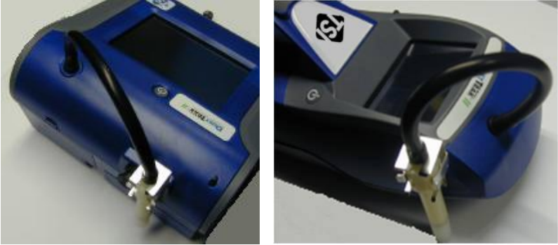
Figura 2-8: Instalación del Ciclón Dorr-Oliver
