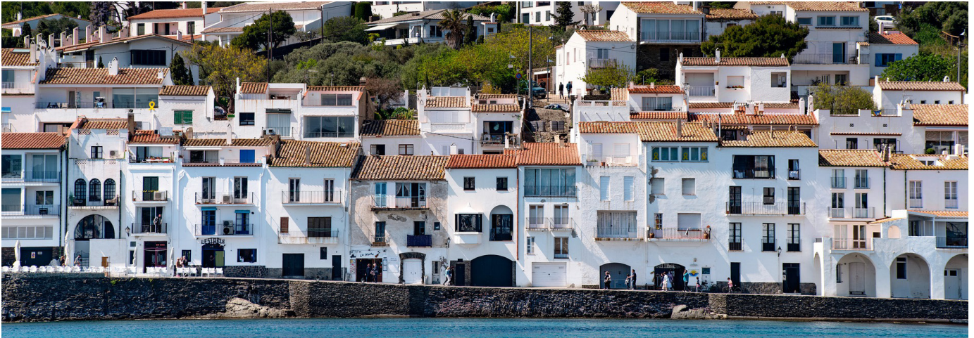
Imatge 18,19. Exemples d'arquitectura tradicional que utilitza superfícies amb alta reflectivitat solar. Font: Pixabay
