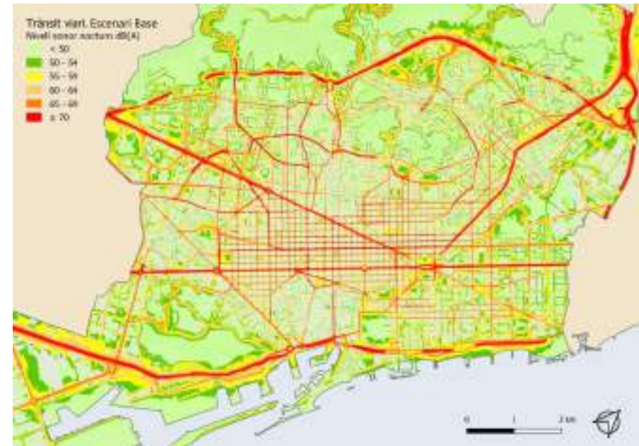
Mapa del nivell sonor del trànsit nocturn ( L_n ) a l'escenari Base 2018. Font: Ajuntament de Barcelona i BCNecologia
