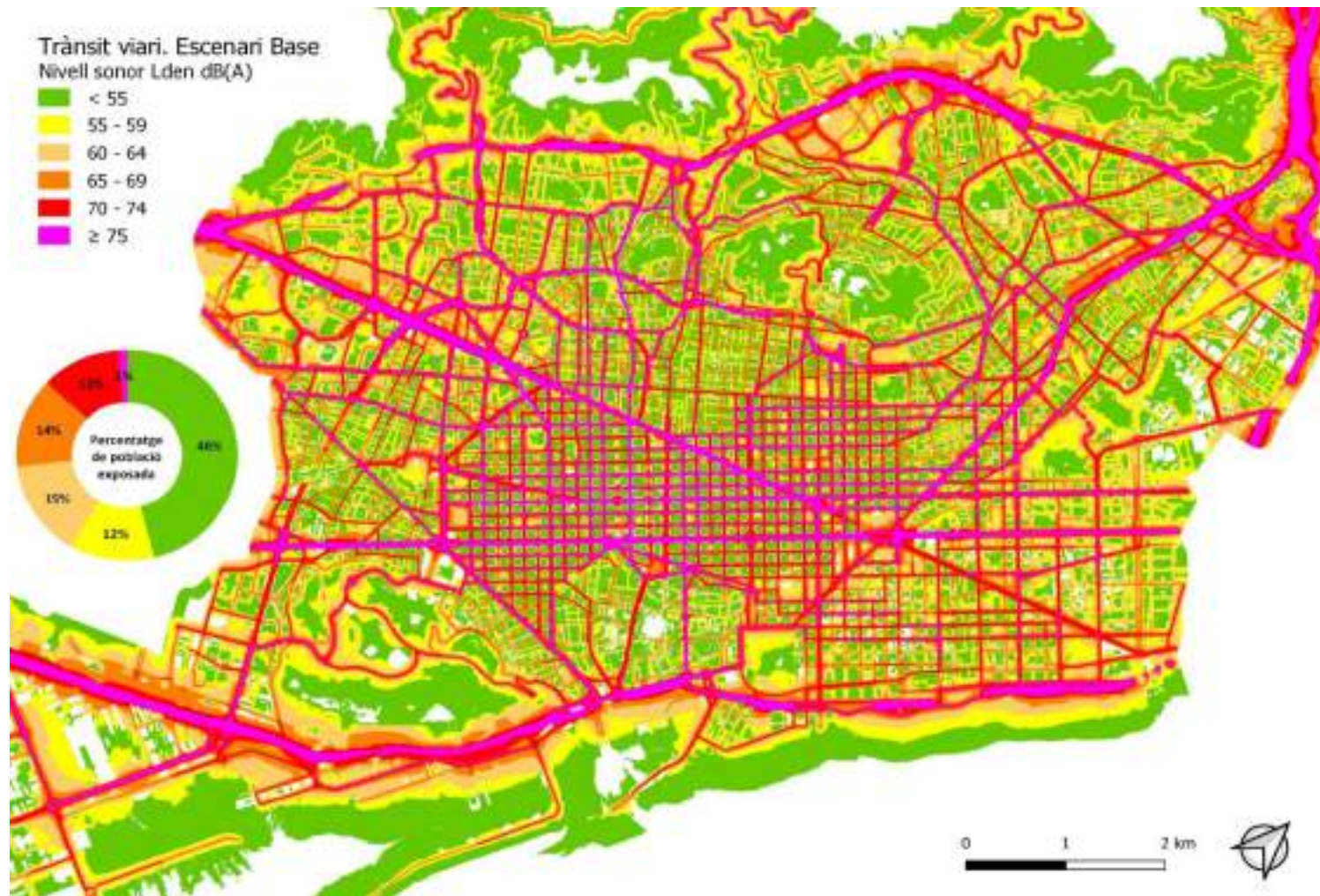
Mapa del nivell sonor de la mitjana energètica L_{den} del trànsit a l'escenari Base 2018.
