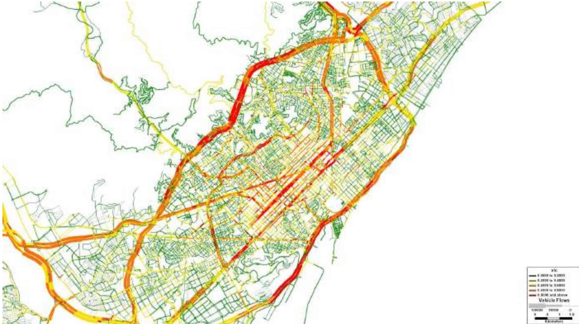
Escenari PMU (2024). Matriu Actual. Mapa de volum de trànsit i Índex de saturació.
