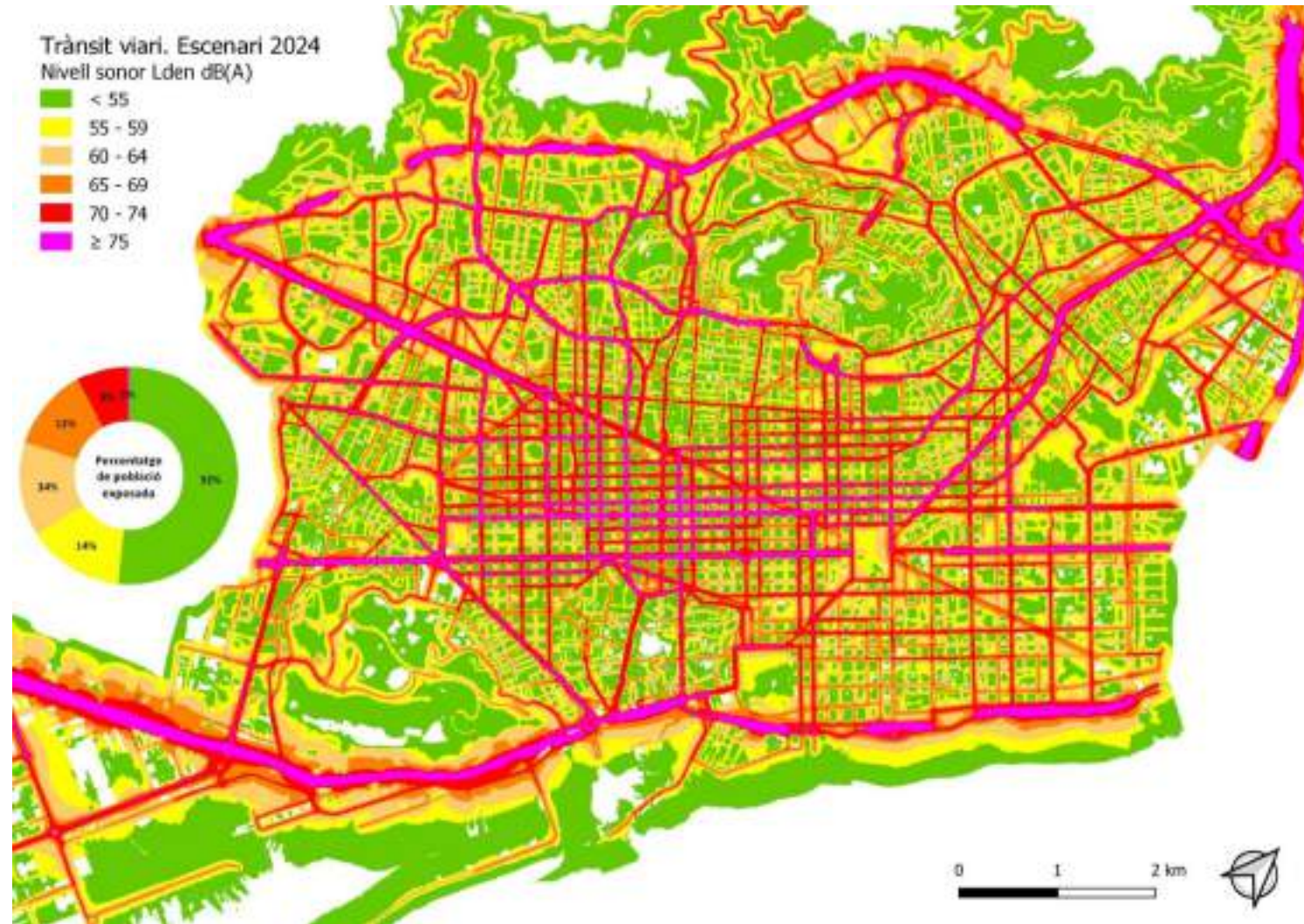
Mapa del nivell sonor de la mitjana energètica Lden del trànsit a l'escenari 2024 (-21 %). Font: Ajuntament de Barcelona i BCNecologia
