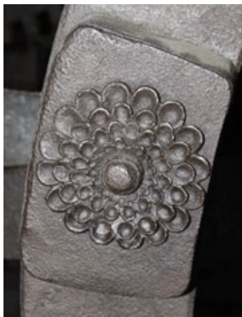
Contrapès de la maneta d'una roda de remuntatge
