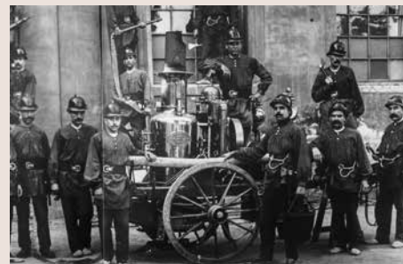
Merryweather Valiant II 1896. Adquisició de 1896. Fabricació anglesa. Bomba d'incendis de vapor lleugera amb un cabal de 900 l/m. Calien un mínim de dos bombers per desplaçar-la. ABB
