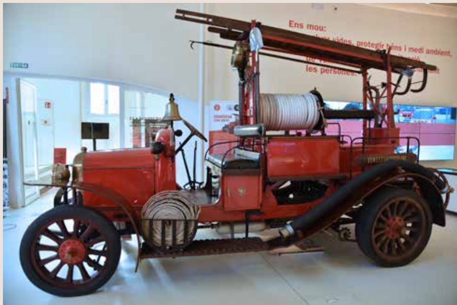
Autobomba Delahaye 84 PS - Genoveva. Adquisició de 1923. Fabricació francesa. Autobomba lleugera amb un dipòsit de 400 l d'aigua per apagar incendis de manera autònoma. ABB
