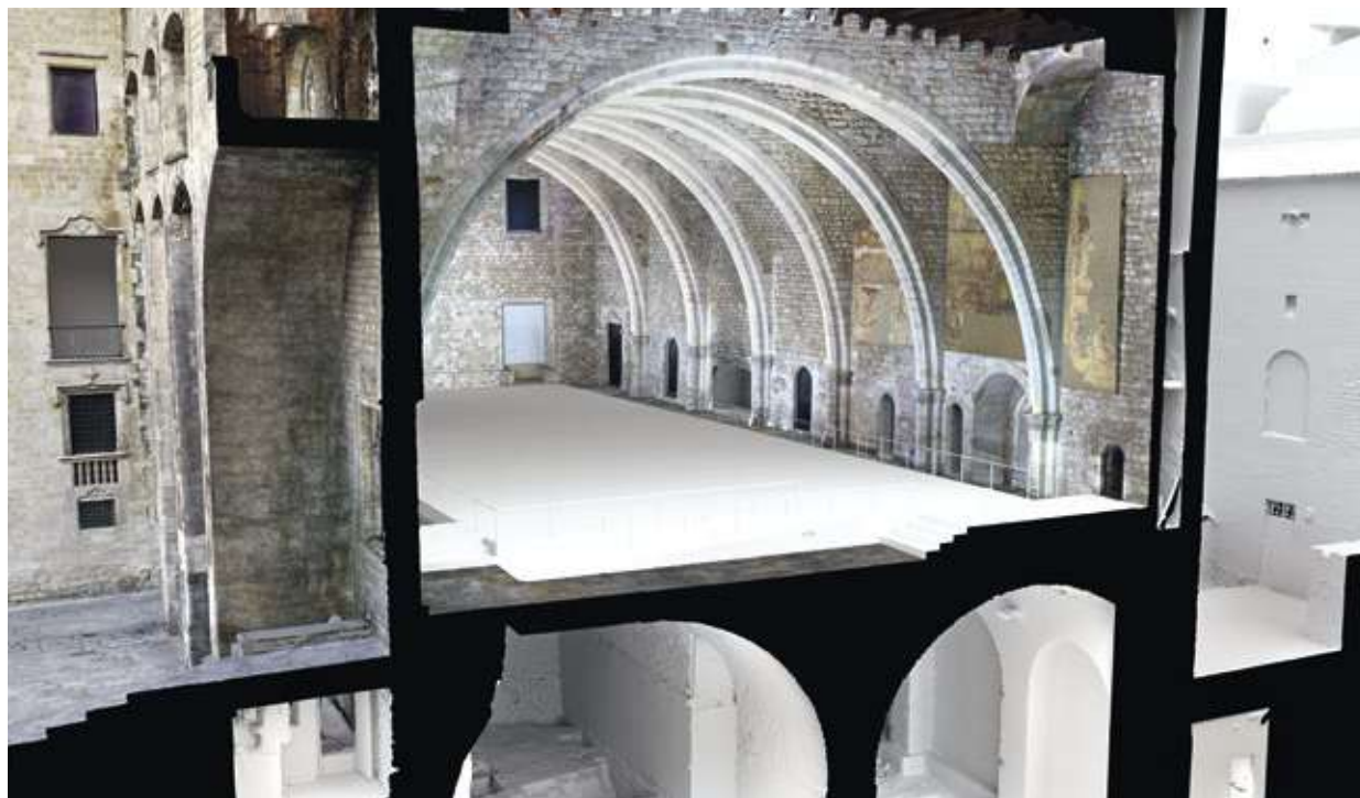
FIGURA 6.3 Secció del Tinell dins la caixa palatina romànica, generada amb escàner làser terrestre i fotogrametria. VIMAC-UPC per al MUHBA
