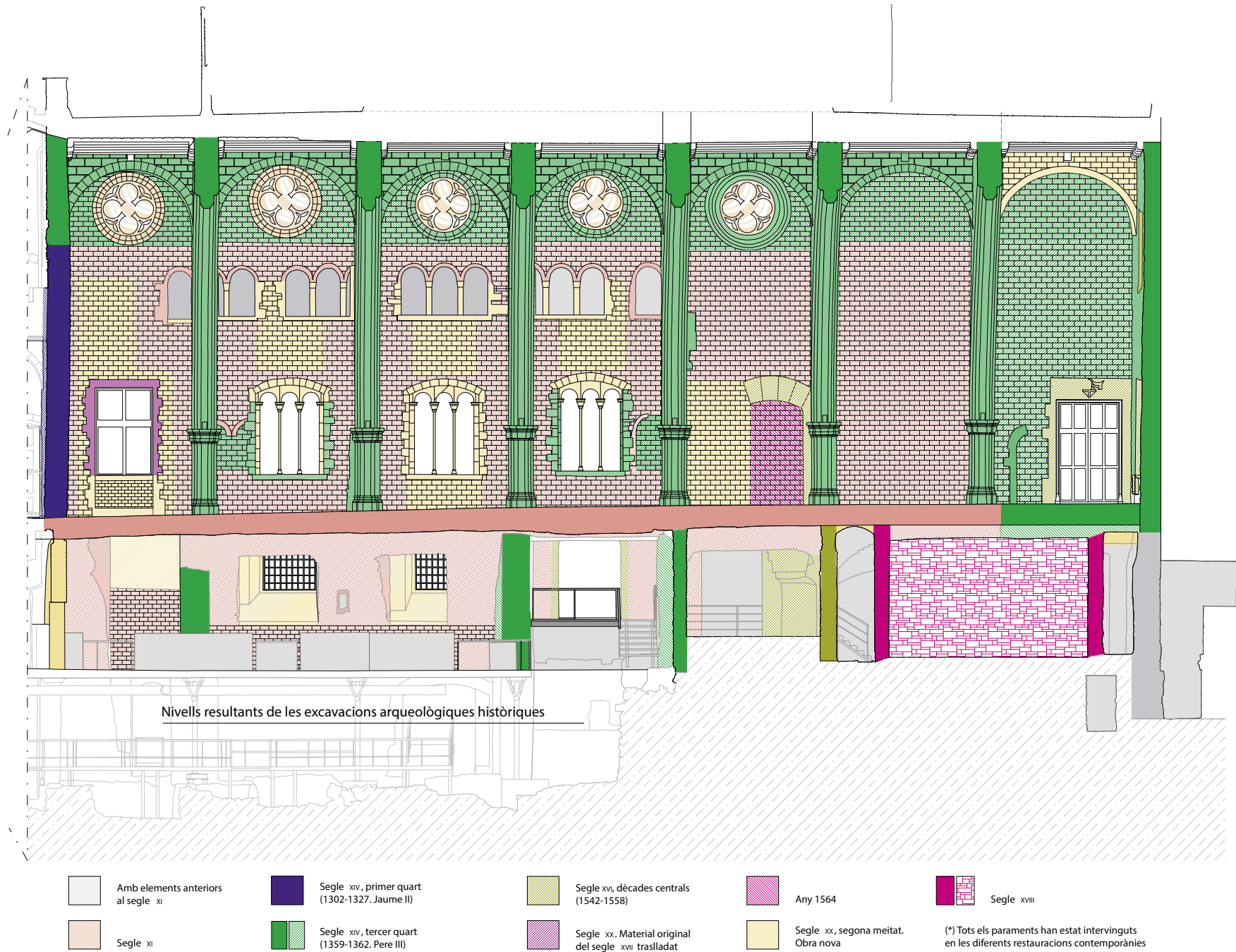
FIGURA 2.17 Alçat interior de la façana principal. Cronologia de les estructures. REALITZACIÓ: Reinald González, sobre planimetria del VIMAC-UPC per al MUHBA
