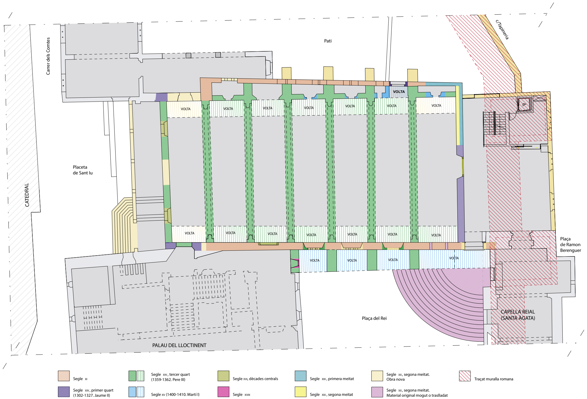
FIGURA 2.3 Planta de la caixa romànica que conté el Tinell gòtic. Cronologia de les estructures. REALITZACIÓ: Reinald González, sobre planimetria del VIMAC-UPC per al MUHBA
