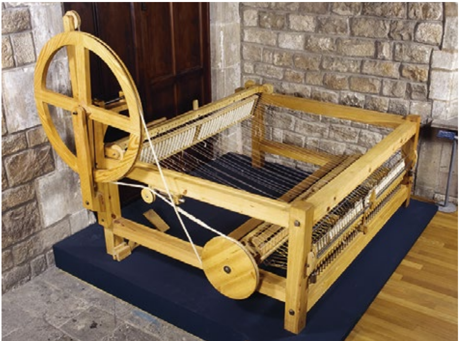
Filadora berguedana o maixerina, més productiva que l'anglesa spinning jenny i construïda pel fuster Ramon Farguell, "Maixerí", a Berga, a la dècada de 1790. Reproducció moderna. MNACTEC
