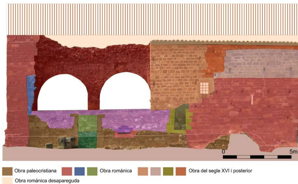
Fig. 4: Alçat del mur exterior sud de l'església de Santa Margarida, amb indicació resumida de la seqüència constructiva i restitució de l'obra romànica desapareguda.
