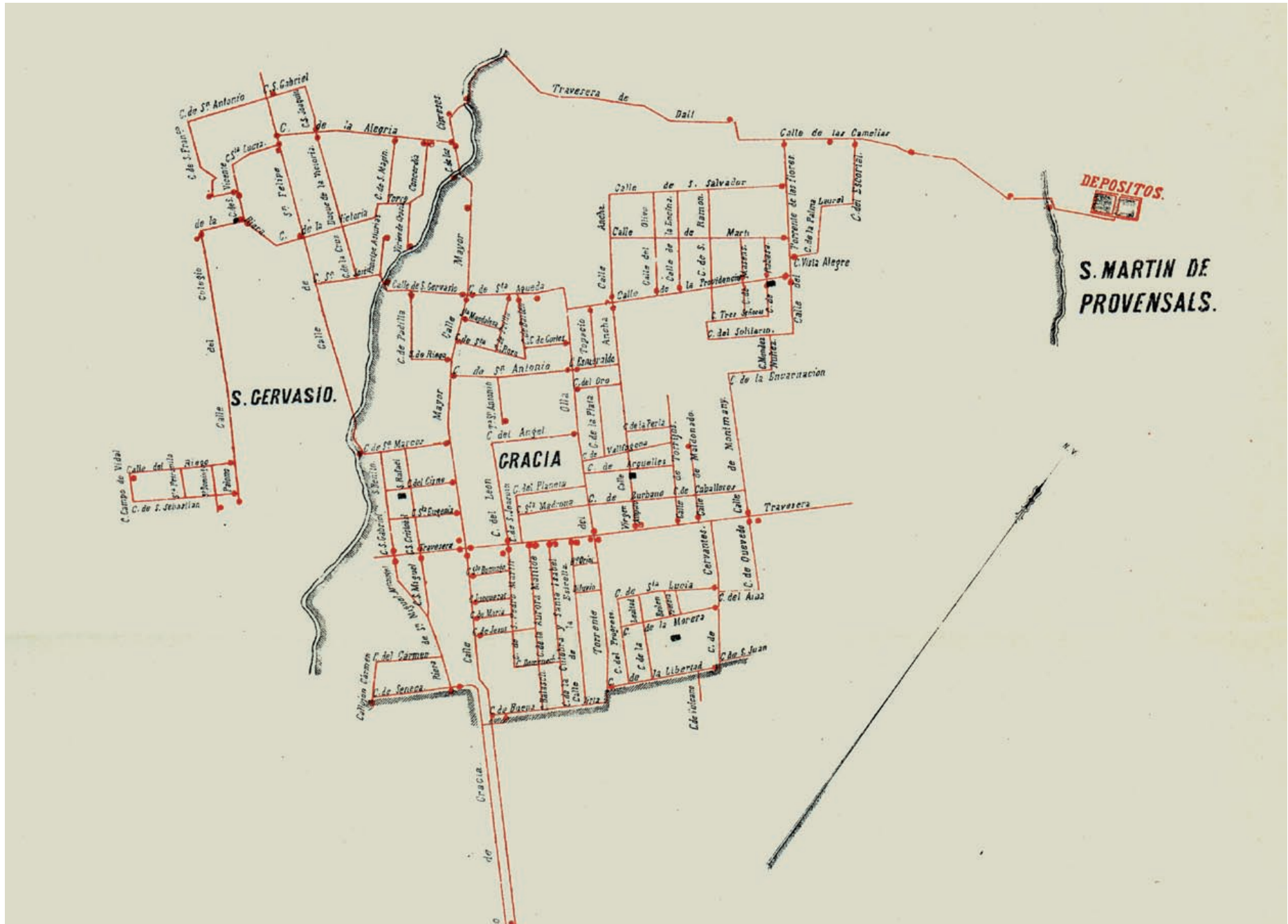
Plano general de distribución de la Compañía de Aguas de Barcelona a principios de 1873, Gràcia y Sant Gervasi, Aguas de Dos Rius. Compañía de Aguas de Barcelona. Sociedad Anónima Belga , Barcelona, 1 de febrero de 1873, AHCB.
