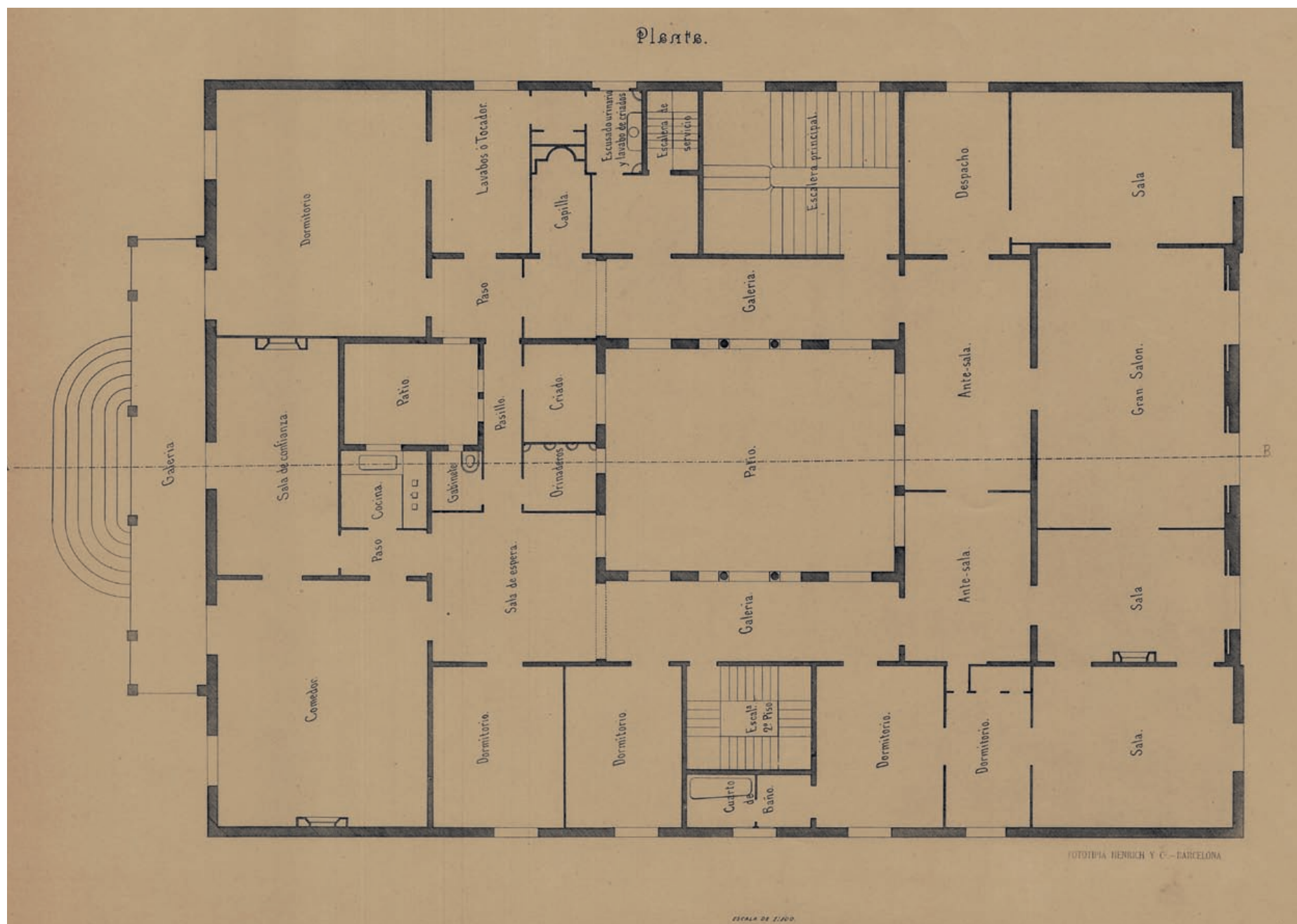
Pedro García Faria, Proyecto de saneamiento del subsuelo de Barcelona , 1891; Heinrich, 1893, AHCB. Los distintos aparatos sanitarios (urinarios, lavabos, water closet , bañera) que proponía en la vivienda modelo se conectaban a la red a través de sifones, pero quedaban separados y todavía no configuraban la «sala de baños». La bañera estaba escondida en un rincón apartado.
