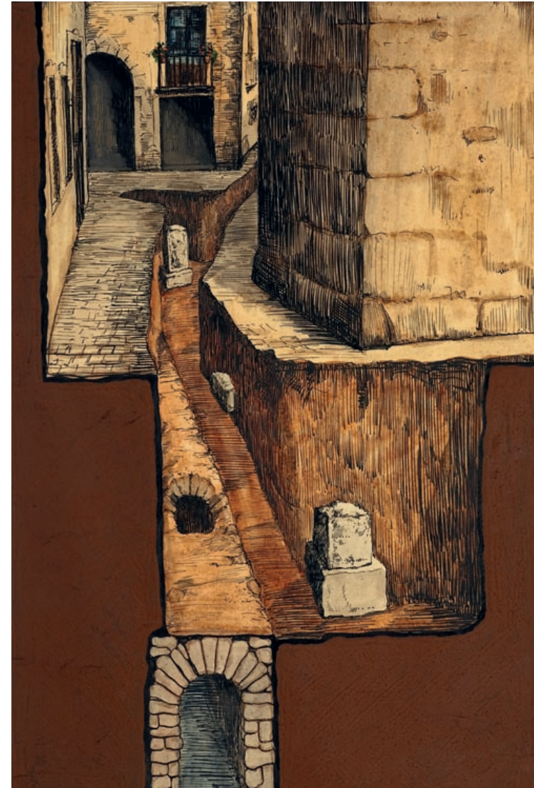
Canalización no presurizada de época romana documentada en la calle Palma de Sant Just que suministraba agua a las instalaciones termales, MUHBA.
