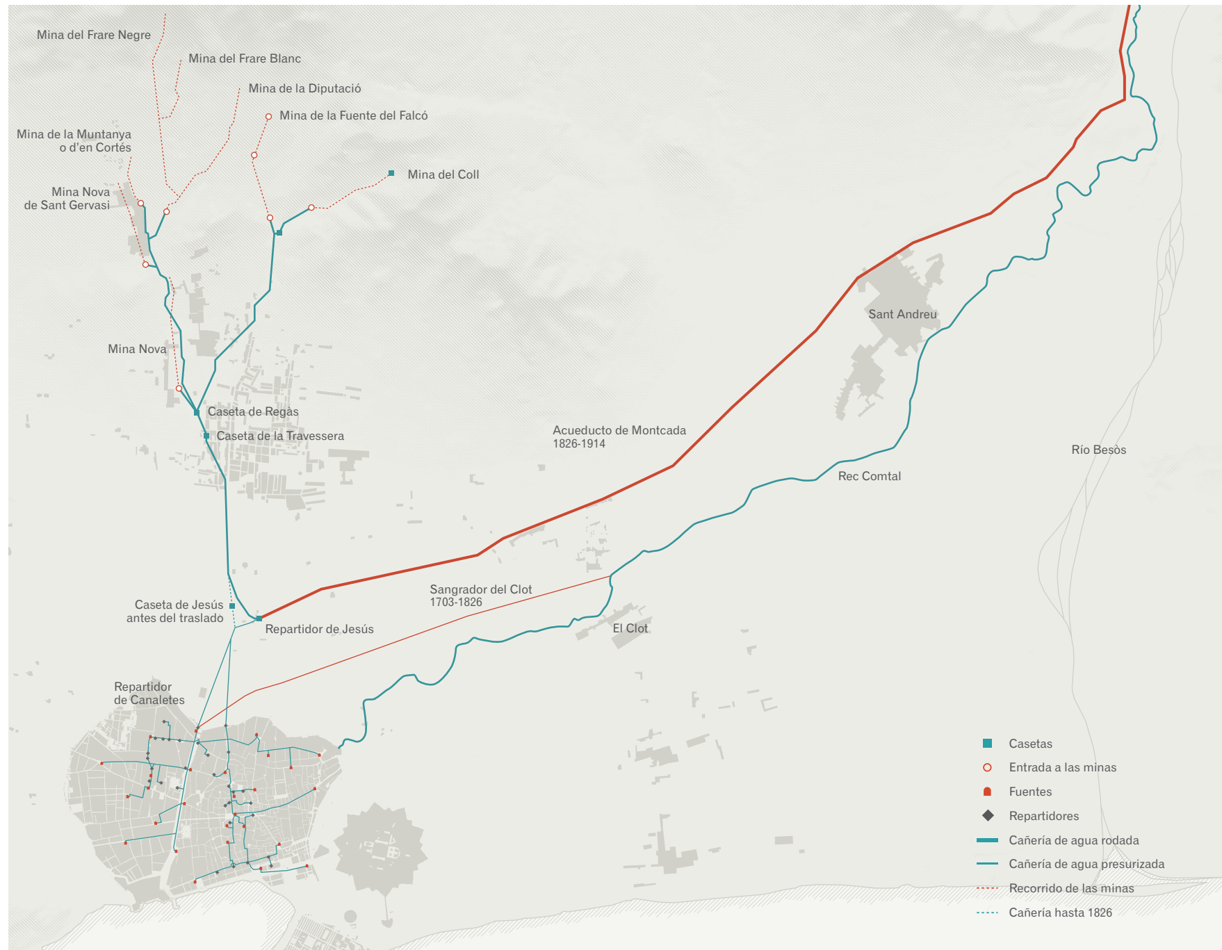
Sistema de abastecimiento de agua de las fuentes de Barcelona de 1800 a 1850 (M. Guàrdia; documentación: X. Cazeneuve, A. Cubeles; dibujo: A. Cerezo).
