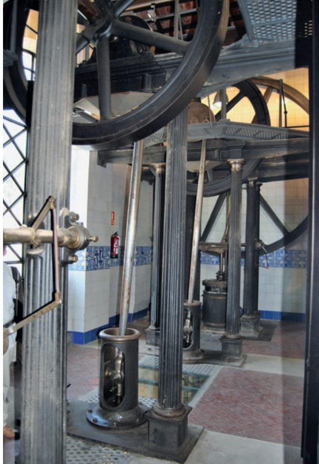
Sala de máquinas de extracción de los pozos de Montcada. Constaba de dos máquinas de vapor Alexander tipo Wof con 100 caballos de potencia. Accionaban cuatro bombas de vapor con capacidad para extraer 23.000 metros cúbicos diarios. El pozo central disponía de dos bombas y los laterales, de otra cada uno, MUHBA.
