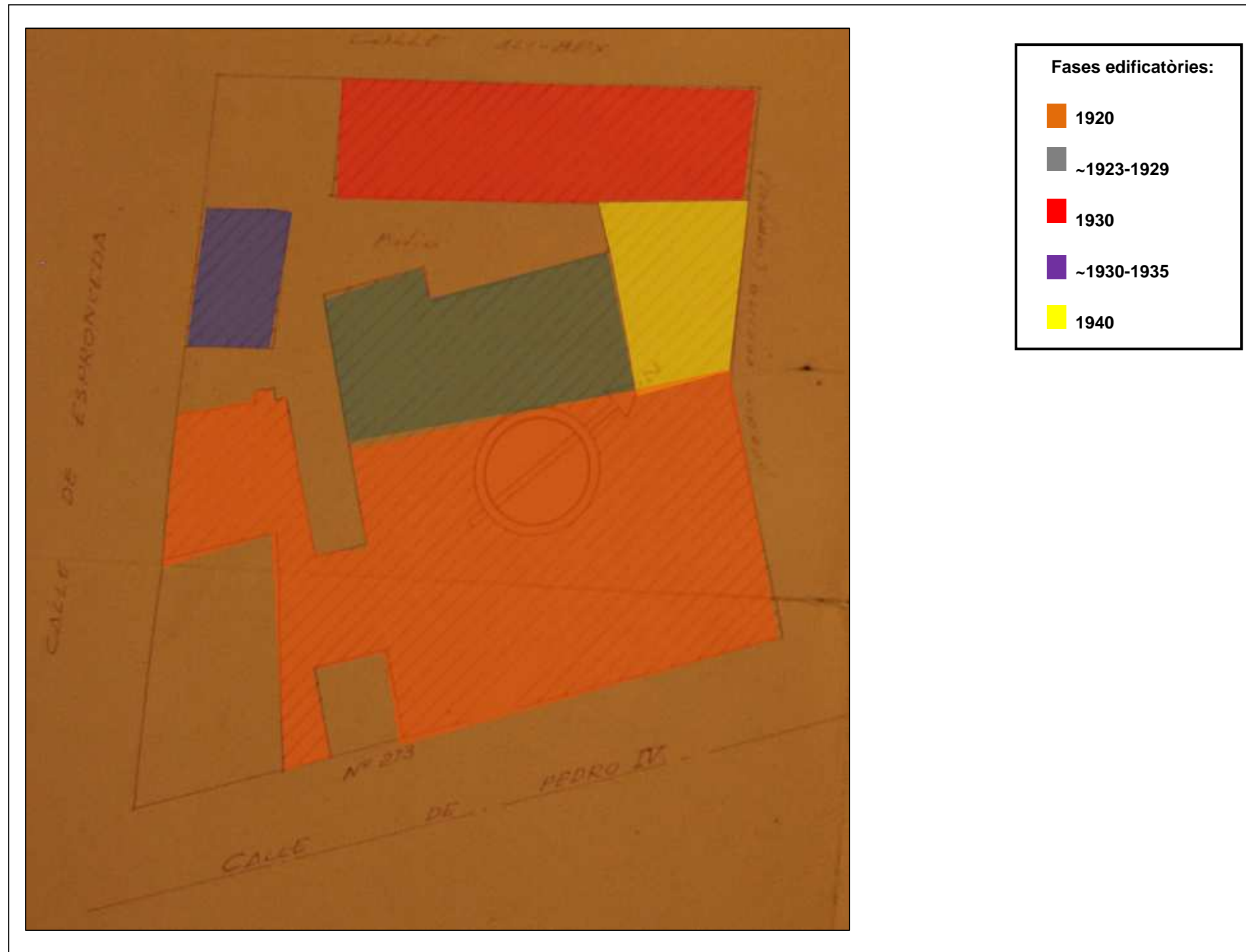
Fases constructives del conjunt arquitectònic del Taller Oliva Artés (obres majors).
