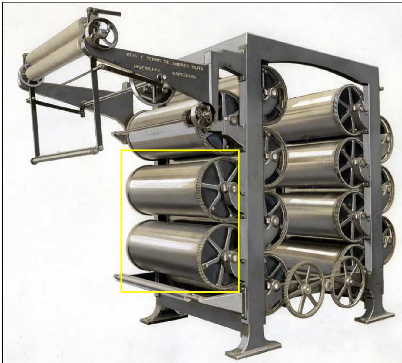
Identificació de les peces-motlles espargides per la planta pis de la nau est: màquina d'assecar teixits (AHPN: reg. 3539).
