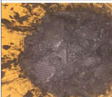
Imagen 5. Vista del residuo seco generado por un sistema de lavado de gases de escape
