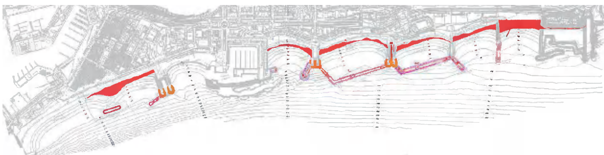
Imatge 15 Obra executada del projecte d'estabilització de les platges de Barcelona (2008)
